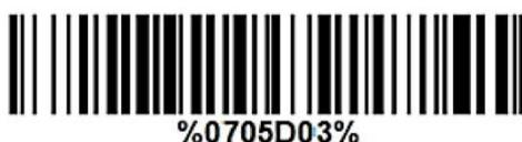
Чтобы снова включить автоматическую очистку памяти после выгрузки штрихкодов, отсканируйте управляющий код (Standard batch):
