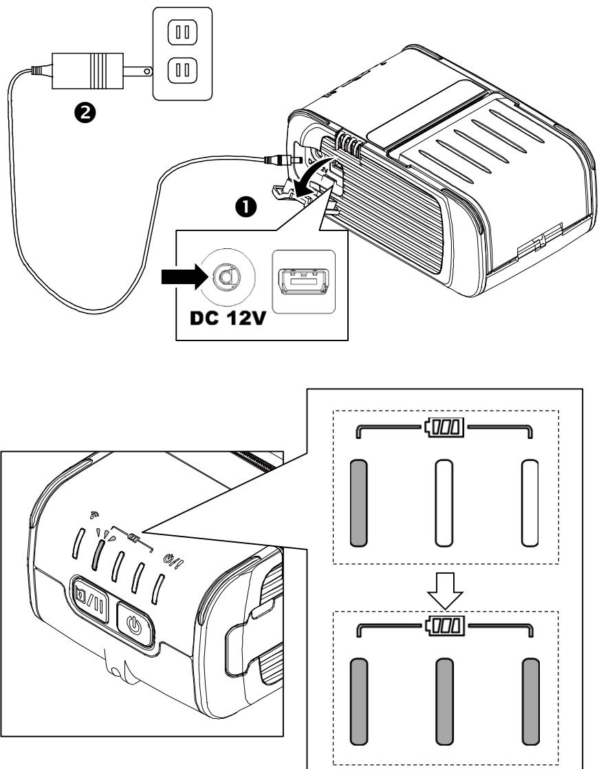
Turn on the Power/開啟電源/开启电源/電源を入れる/Включение принтера/Schalte den Strom an/Allumer l'appareil/Conectar la alimentación/Accendi il potere/شُفَّل الطاقة
